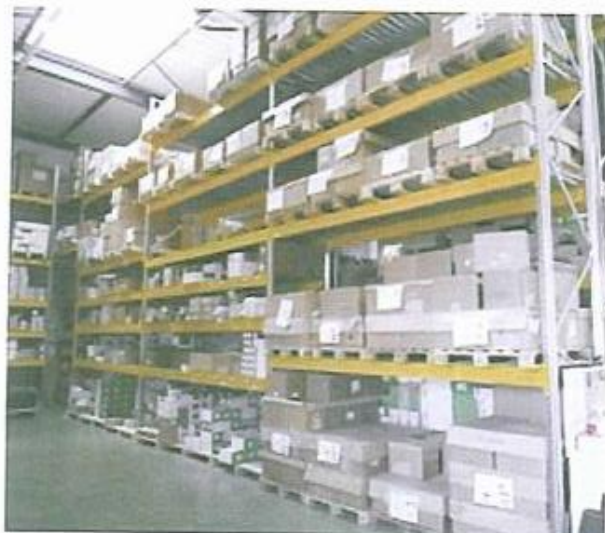
■ Vue générale du stockage statique sur palettes en rayonnages double face (doc. JAM France).
