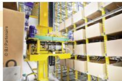
Dans le transstockeur : de grandes quantités de produits à très forte rotation (A+) réalimentent le libre-service rangé dans des armoires dynamiques. On y trouve aussi des produits de volumétrie moyenne, de moyenne et de faible rotation (classe B et C), qu'il est nécessaire d'avoir en stock pour assurer convenablement le service du client.
