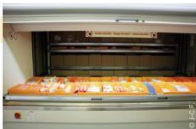
Dans la tour de stockage : des pièces de typographie allant de moyenne à petite, de classe A, pour lesquelles la rapidité de service s'impose.
