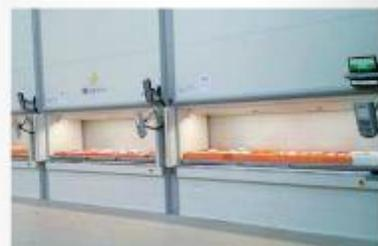
sont des petits volumes et ils sont déposés dans des contenants fixes sur les plateaux des stockeurs Hanel. « Le système WCS (Warehouse Control System), intégré aux stockeurs, nous permet de gérer les flux, soit commande par commande, soit par rafale. » souligne William Duver. Les stockeurs sont utilisés en moyenne 5 à 6 heures par jour. Ils accompagnent le processus de préparation de commandes, notamment lors du pic de production qui se déroule entre 15 et 16 h. ● A.M. et P.L.G.B.
